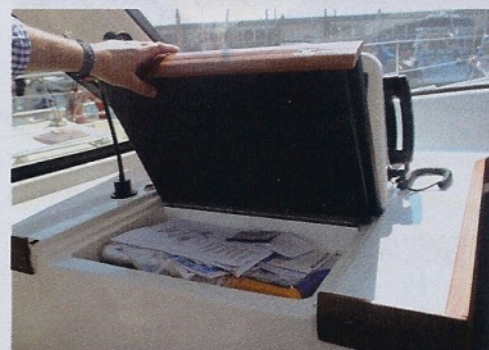
Se aprovecha el módulo de la parte superior de la cabina de babor para colocar la mesa de cartas y la electrónica.
