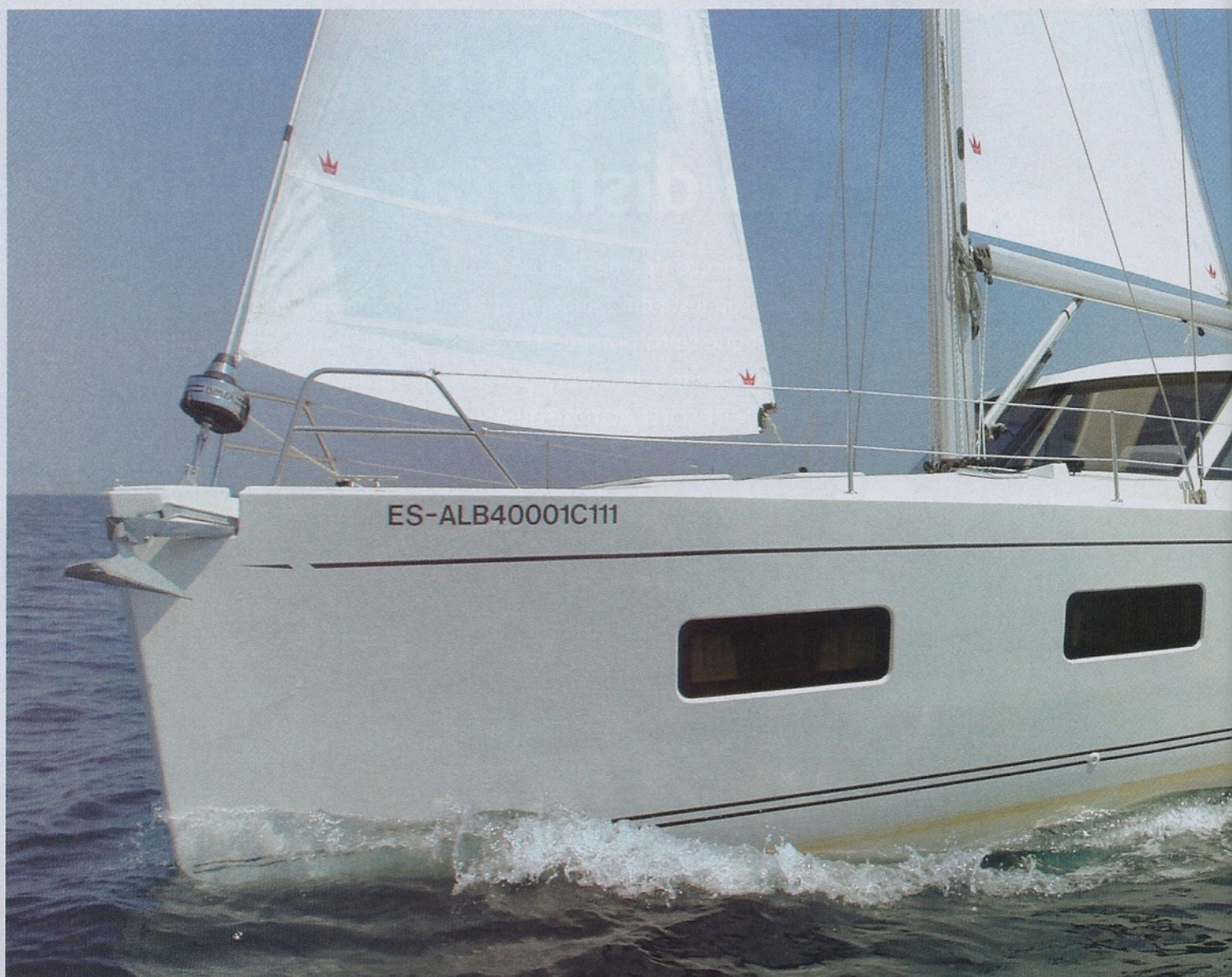
La roda y el espejo prácticamente rectos, permiten aprovechar al máximo la eslora. El casco adquiere arista en el tercio de popa, lo que favorece el asiento.
