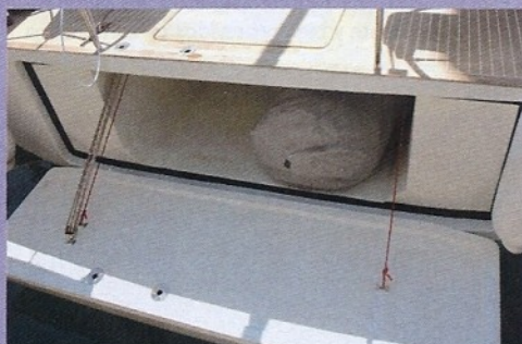
Un espacioso garaje con portón abatible en el espejo de popa permite la estiba del anexo o de gran cantidad de pertrechos.
